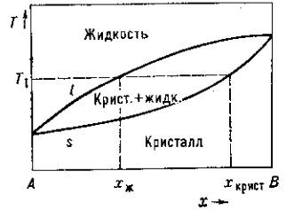
Рис. 3. Диаграмма состояния кристалл — жидкость двухкомпонентной системы, x — атомная (молекулярная) доля компонента В в растворе.
