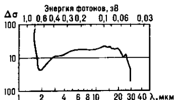
Рис. 3. Спектральное распределение примесной проводимости в Ge, связанное с примесью Cu.
